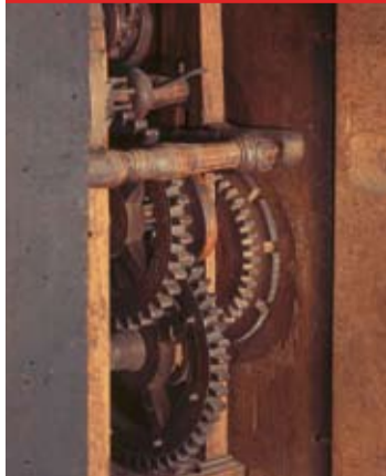
Mécanisme de l'horloge à foliot à roue en bois ancienne, région de Berne, 2 e moitié du XVII e siècle
