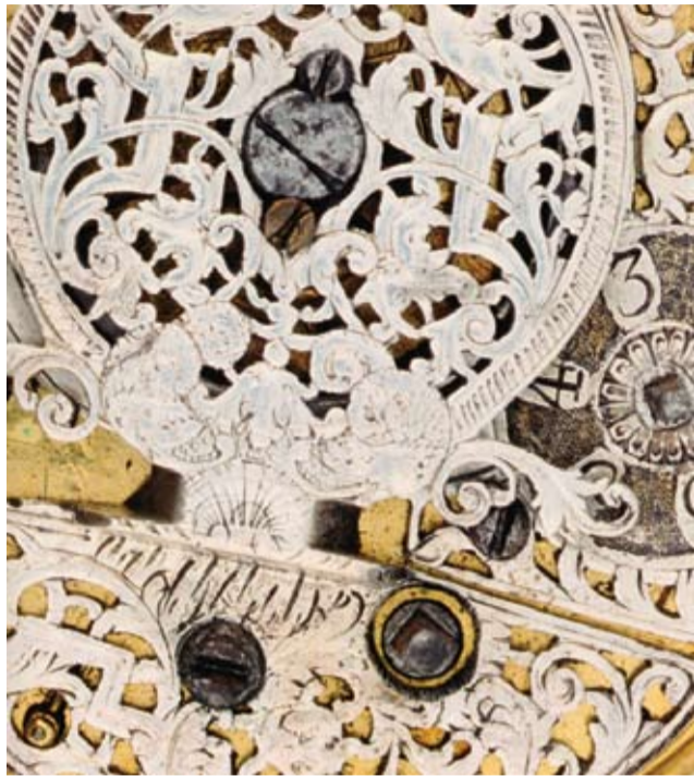
Mécanisme de l'horloge de Paulus Bengg, XVII e siècle
